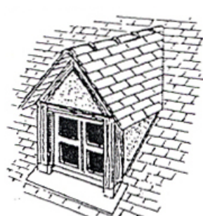
lucarne à deux pans dite jacobine, en bâtière ou à chevalet
